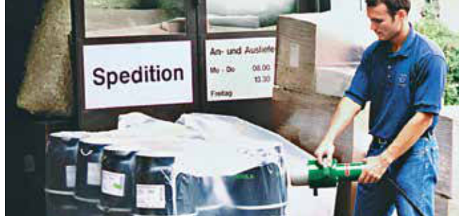
Termoretrazione senza fiamme libere di pallet e merci ingombranti in ambienti chiusi.
