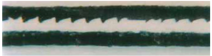
Saldatura con ugello grip, 25% in più di resistenza delle cuciture di saldatura. principalmente per geomembrane TPO.
