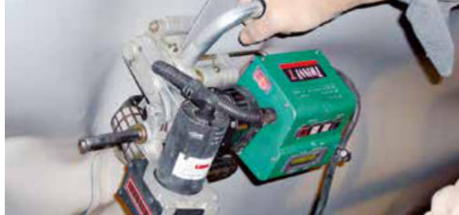
TWINNY T con maniglia trasversale pratica per la saldatura aerea all'interno di tunnel.
