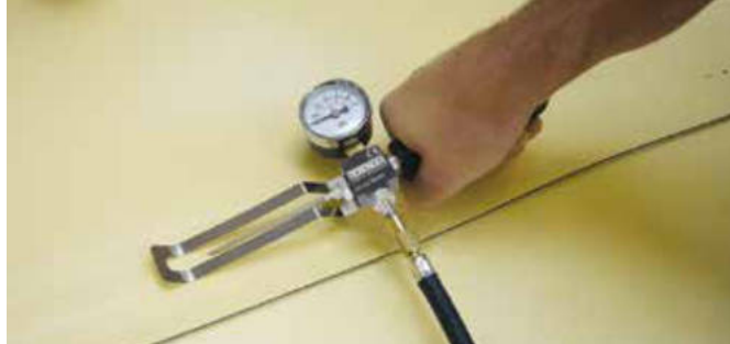
Prove di tenuta di cordoni in sovrapposizione con canale di controllo.
