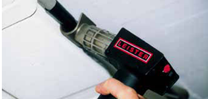
Termoretrazione d'isolamento di cavi elettrici con il GHIBLI.
