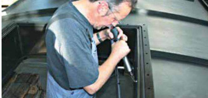
DIODE PID durante la saldatura a estrusione di un contenitore in PE.
