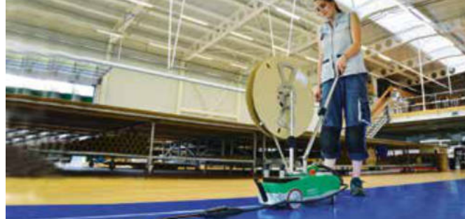
Saldatura economica ed ergonomica di nastri di rinforzo.
