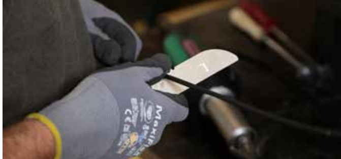
Rimuovere lo strato di ossido dal cordone di saldatura.
