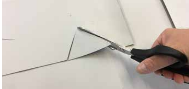
Forbici Leister con speciale lama seghettata per grandi esigenze nel taglio delle guaine di plastica.
