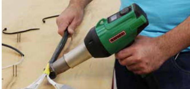
Termoretrazione nell'assemblaggio di cavi – ideale con GHIBLI AW
