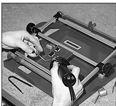
Enlèvement de restes d'étain au moyen d'air chaud et d'une tresse
