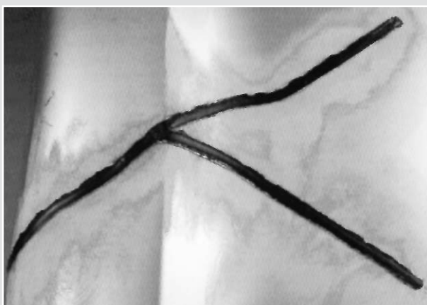
La baguette après soudage doit dépasser légèrement au dessus de la surface de la pièce et être lisse.
