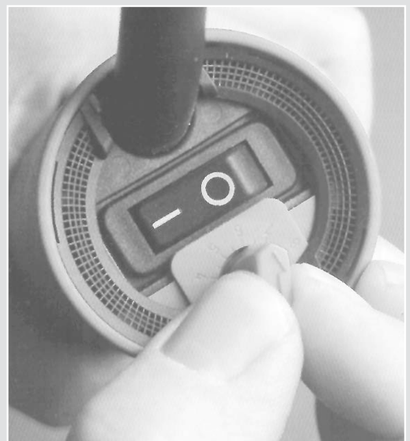
Potentiometerknopf an der Rückseite des Heissluftschweißgerätes ermöglicht eine genaue Regelung der Schweisstemperatur bis 700° C.
