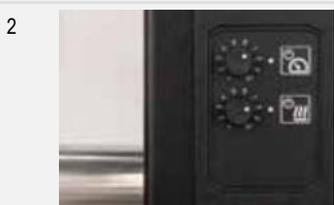
Zone de commande : Avec l'unité de commande intuitive, vous allez réaliser des soudures sans aucun stress. La température et la vitesse se règlent en toute simplicité. Le mode cool-down intégré permet à la machine de refroidir en douceur.
